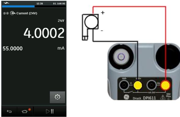
图 2-18在电气通道范围 $\pm 55 \text{ mA}$ 时测量电流
