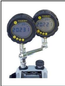
为更加高效，一次可以同时安装2个测试仪，适配器连接DPI611端口，提供2排端口，兼容标准适配器及其套件。
