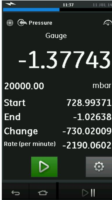
图 2-25 泄漏测试图示
